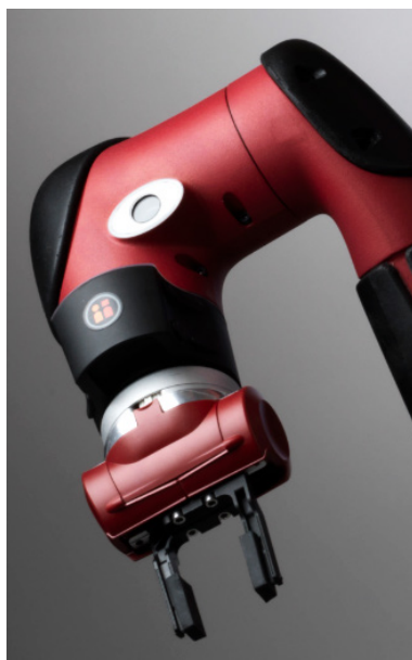
Eingebautes Kamerasystem mit Cognex Kamera
